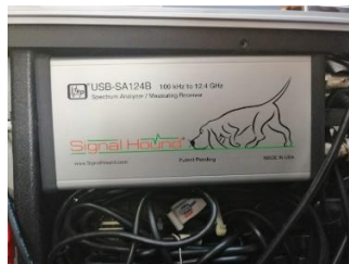
Рисунок 2 – Модуль анализатора спектра USB-SA124B (100 кГц-12.4 ГГц)
