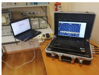
Рисунок 1 – Пример измерения уровня мощности сигнала частоты 2400 МГц от USB-генератора на анализаторе спектра БАРС
